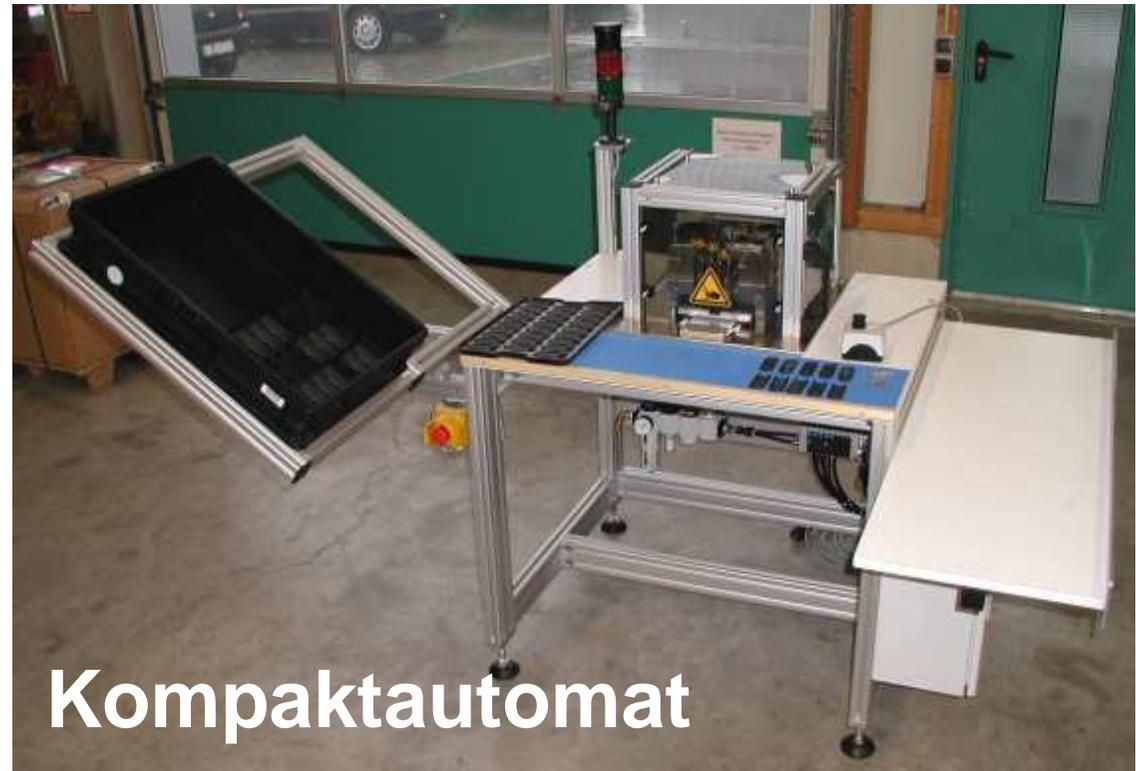
Die Teile werden von einer Bedienperson vormontiert und in die Aufnahme eingelegt.
