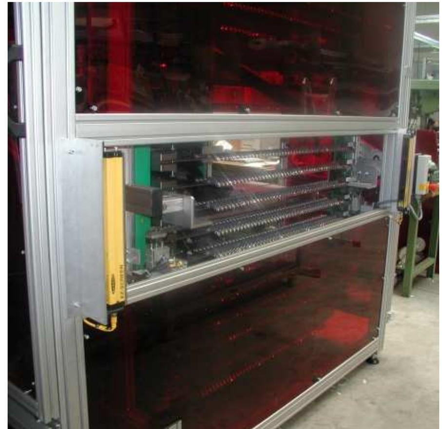
Einfaches manuelles Bestücken und Entleeren des Magazins
