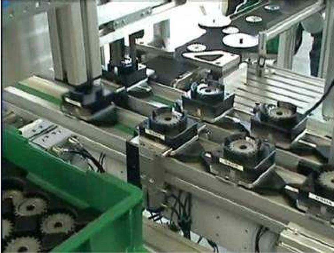
Geprüfte GUT-Teile werden einzeln von den Werkstückträgern des Prüfkreislaufes entnommen und mehrlagig in einem KLT mit Blistereinsatz palettiert.
