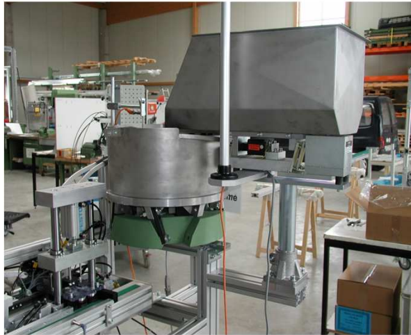
Automat. Montagestation mit Schüttgut-Teile-Bunker, Schwingförderer, Doppel-Vereinzelung, Zuführung mit Maß-Prüfung und n.i.O.-Teile-Ausschleusung
