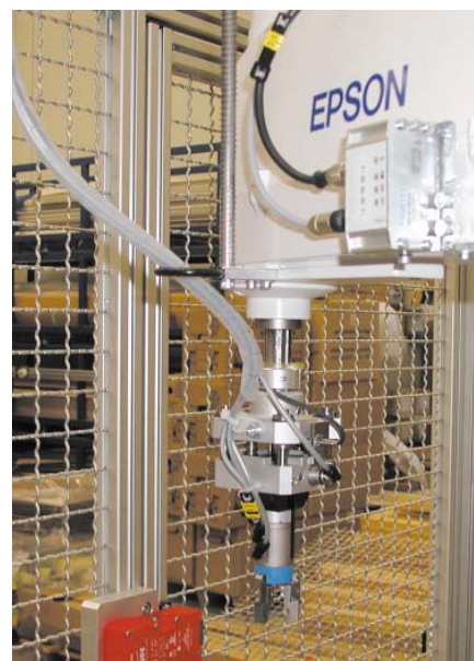
Bild 3 Der Roboter-Spezialgreifer reiht die empfindlichen Bauteile schonend aneinander.
