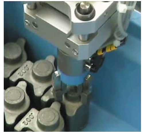
Präzisions-Warmformteile werden bei Hirschvogel im 4-Sekunden-Takt direkt nach der Presse im automatischen Durchlauf geprüft.
