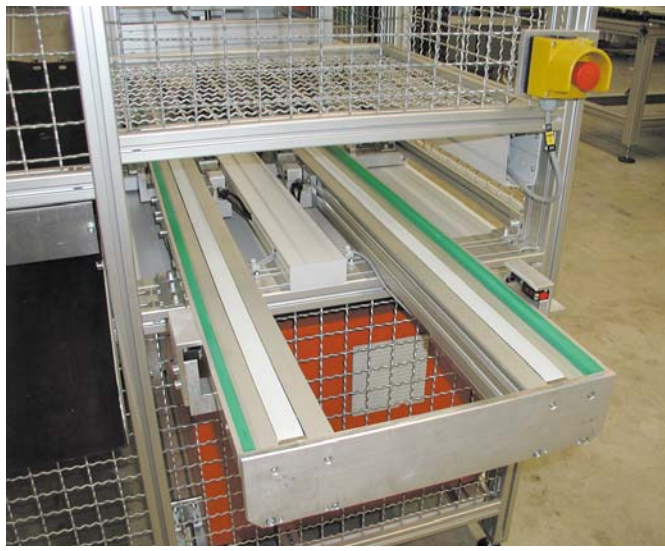
Bild 2 Kleinladungsträger-Aufgabe mit Ausschleusung der n.i.O. (nicht-in-Ordnung)-Teile.
