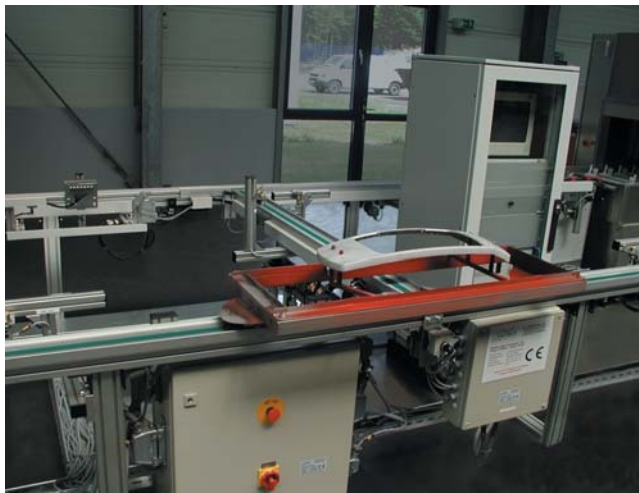
Bild 3 Ausschleusung nach der Prüfung und Zuführung am Bedienarbeitsplatz.
