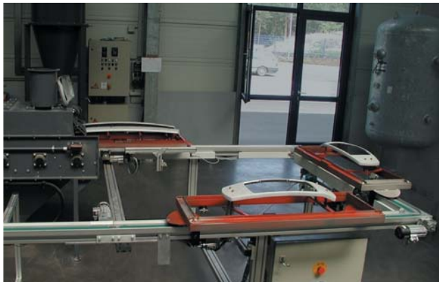
Bild 2 Richtungsorientiertes Umfahren von 180°-Bögen mit WT-„lang“.
