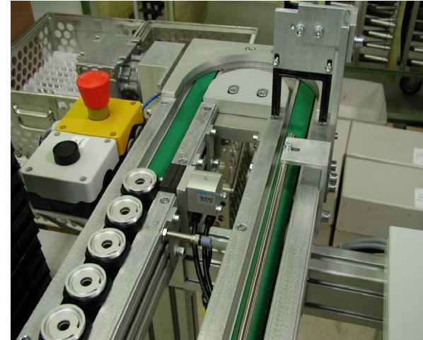
WT - rund zur drehlagerichtigen Transport-Verknüpfung mit platzsparender 180°-Umlenkung
