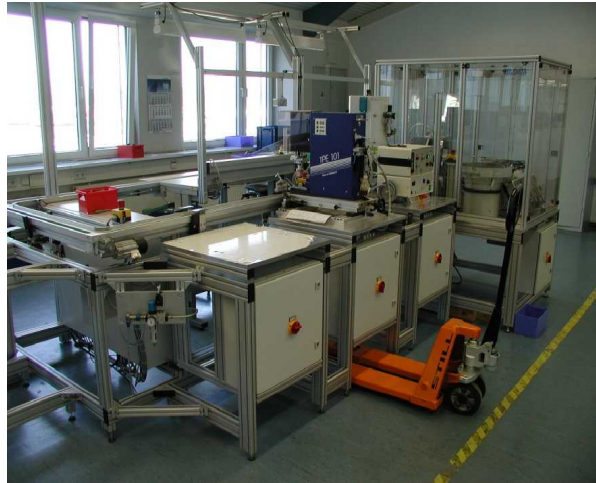
Die kompakte Anlage mit austauschbaren Automatikstationen zur flexiblen Konfiguration
